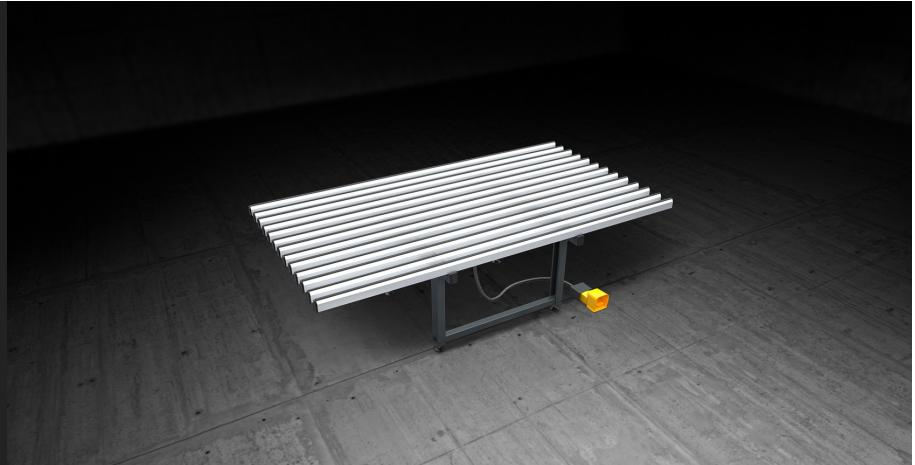
Bancada para a ensamblagem de folhas e marcos. Bancada horizontal com troca pneumática entre o plano de apoio de PVC macio antideslizamento (para a fase de ensamblagem) e o plano de apoio de PVC duro antifricção (para a fase de movimentação). O plano de usinagem é ajustável em altura de 895 a 965 mm. e os pezinhos estão equipados com furos para a sua fixação no solo.
