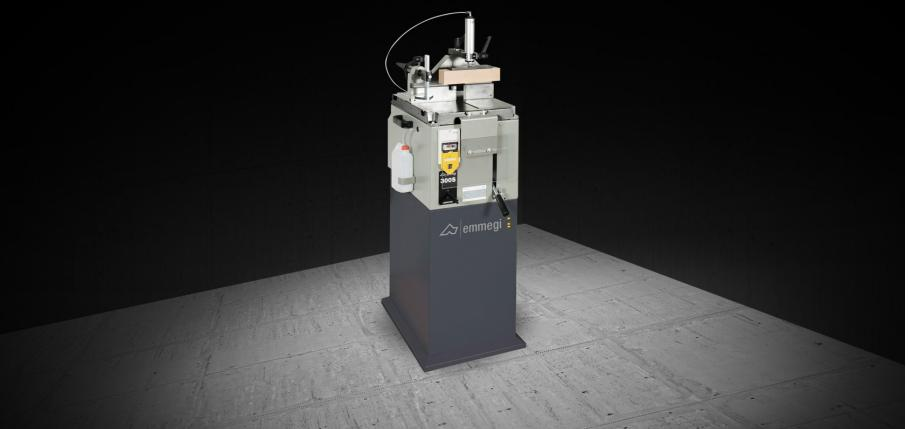
Máquina de corte monocabeça ascendente prevista para cortes a 90°, 45° à direita e à esquerda e ângulos intermediários.
