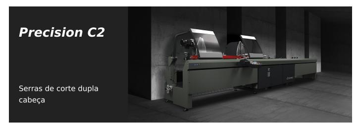
Máquina de corte com cabeça dupla eletrónica e com movimento automático da cabeça móvel através de motor Brushless comandado por controlo numérico. Inclinação pneumática das unidades de corte de 90° até 22°30′ (externa) com sistema mecânico de regulação dos ângulos intermédios. Avanço óleo-pneumático do disco de cort
