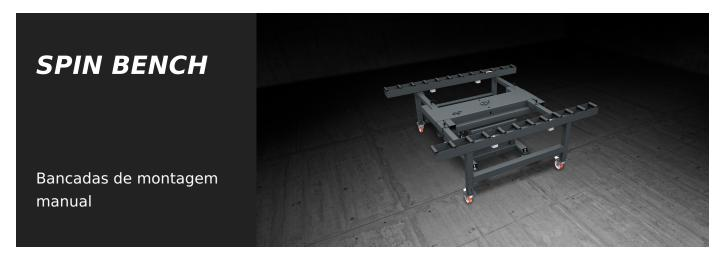
Bancada modular dedicada à ensamblagem e à movimentação em linha de células de fachada. Está implementada com 2 pistas de roletes revestidos com bainha de PVC macio; a distância entre as duas pistas é regulável de acordo com a amplitude da esquadria. Um sistema acionável pneumaticamente permite bloquear os roletes durante as fases de usinagem. A inteira bancada pode girar de 360° para facilitar as operações de ensamblagem e vedação da célula; a posição angular é bloqueada com comando pneumático.
