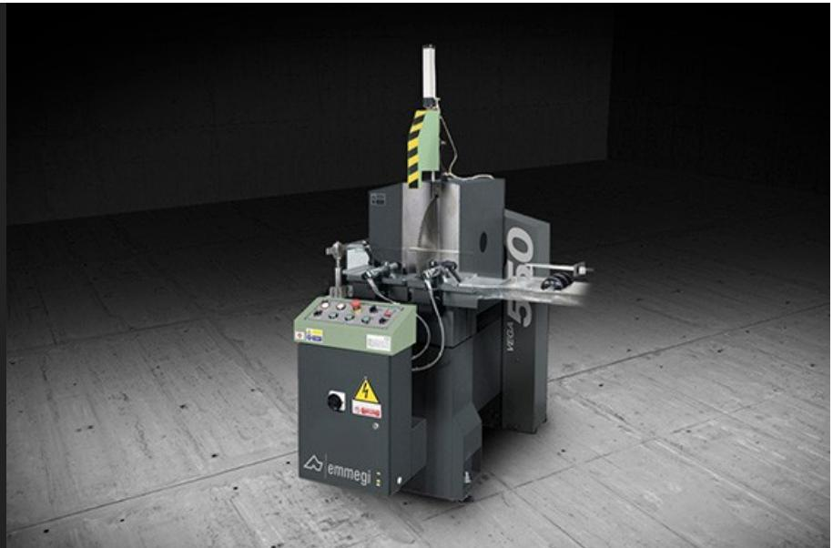
Máquina de corte monocabeça com lâmina de corte frontal, lado de carga à esquerda e duplo basculamento lateral com comando pneumático em posições fixas: 45° à esquerda e 90°, 45° e 22°30' à direita. Um específico encosto mecânico permite também o corte em ângulos intermediários.
