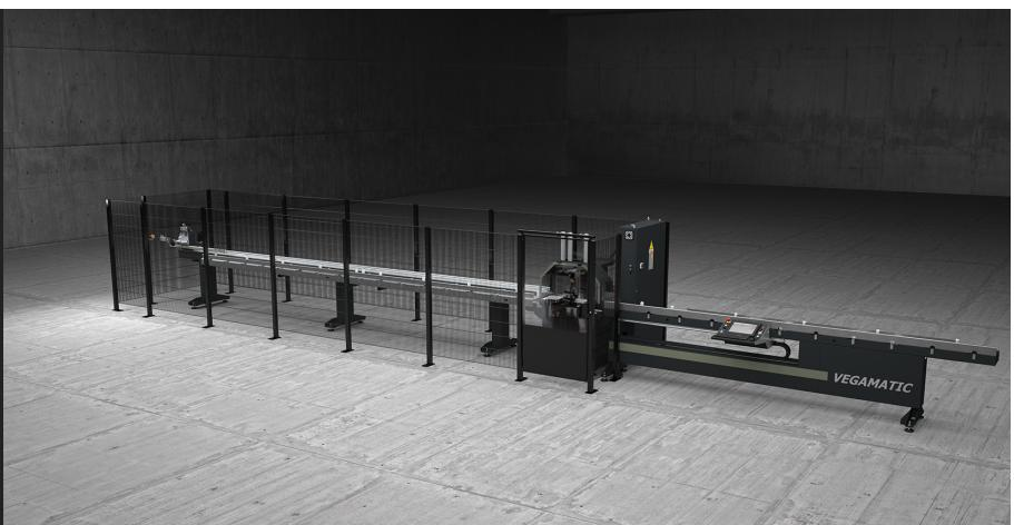
Centro de corte em versão semiautomática com 2 eixos controlados, carga/descarga manual no mesmo lado da máquina, com disco de corte frontal a CNC específico para o corte de perfis em alumínio, PVC e ligas leves em geral. Efetua automaticamente as listas de corte predefinidas e otimizadas. Previsto para efetuar cortes com ângulos de 45° a 135° ou de 22°30' a 157°30'. Configurável com unidade de perfuração horizontal ou vertical personalizável para usinagens automáticas específicas.
