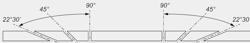
Механическая регулировка промежуточных углов наклона
