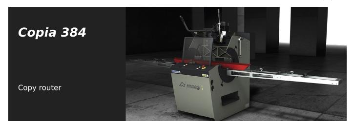
Одноголовочный пантограф с ручным приводом, пневматической блокировкой и перемещением головки с помощью непрямого рычага. Регулируемая скорость вращения инструмента с электронным вариатором позволяет обрабатывать сталь толщиной до 2 мм и улучшает качество фрезерования и срок службы инструмента. Возможность сквозной обработки алюминия без поворота заготовки. Щуп с ручным управлением.
