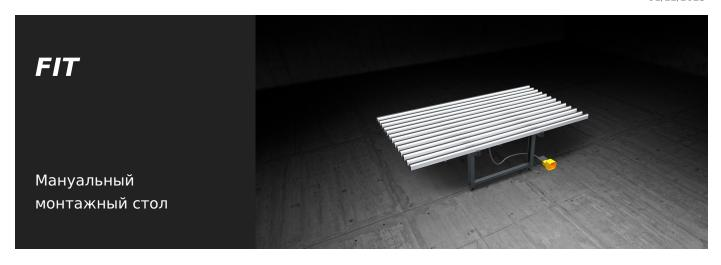
Сборочный стол для створок и рам. Горизонтальная рабочая поверхность с пневматической сменой опорных столов, покрытым мягким противоскользящим ПВХ (для этапа монтажа и сборки) и покрытым твердым антифрикционным ПВХ (для этапа перемещения). Рабочий стол регулируется по высоте в диапазоне от 895 до 965 мм, а опорные ножки оборудованы отверстиями для крепления к полу.
