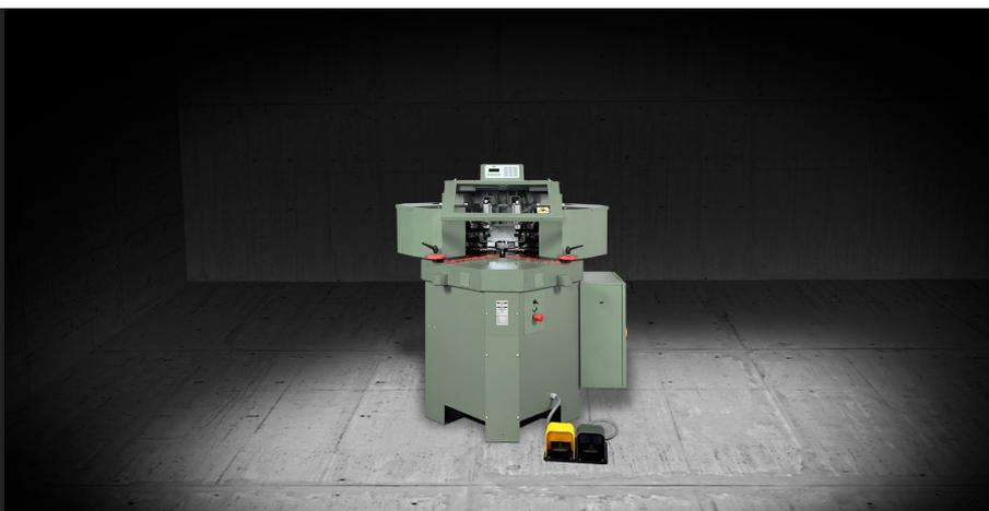
Станок оснащен двумя специальными рабочими головками, оборудованными массами, в которых 2 ножа регулируются во всех положениях снятия фасок. Ножи перемещаются и регулируются по оси Y (вдоль профиля), по оси Z (вверх-вниз) и по оси X (по направлению снятия фасок). Эти условия позволяют избежать смены инструментов на станке независимо от различных типов профиля. Таким образом сокращается время и расходы на переналадку.
