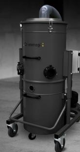
Система всасывания стружки из алюминия и ПВХ с двойным всасывающим патрубком предназначена для очистки станков и рабочих мест. Использование канальной турбины высокой мощности делает ее пригодной для различных требований к всасыванию. Оснащена антистатическим фильтром и подходит для всасывания стружки из алюминия, стали и ПВХ, комплектуется быстросъемным баком для сбора стружки на колесах.
