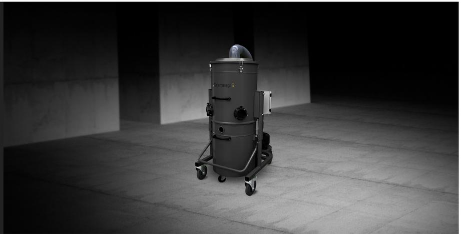
Система всасывания стружки из алюминия и ПВХ с двойным всасывающим патрубком, оснащена автономным питанием и автоматическим запуском от станка, предназначена для очистки станков и рабочих мест. Использование канальной турбины высокой мощности делает ее пригодной для различных требований к всасыванию. Оснащена антистатическим фильтром и подходит для всасывания стружки из алюминия, стали и ПВХ, комплектуется быстросъемным баком для сбора стружки на колесах.
