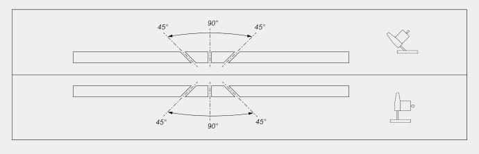
Механическая регулировка промежуточных углов наклона
