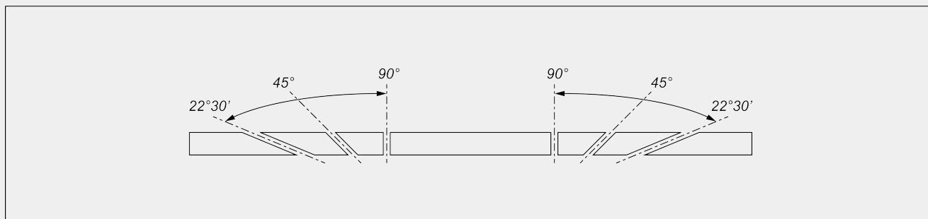
Механическая регулировка промежуточных углов наклона
