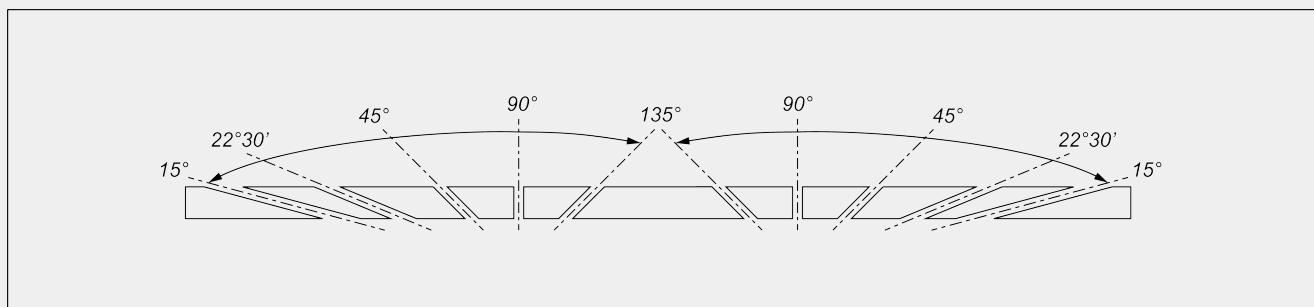
Электронная регулировка промежуточных углов наклона
