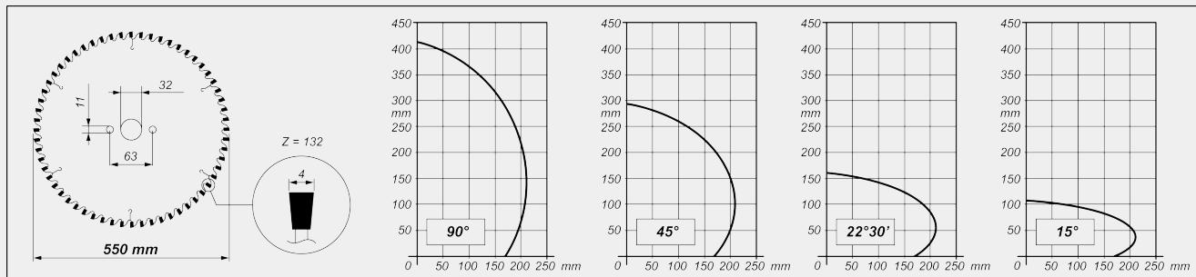
**НАКЛОН РЕЖУЩЕГО УЗЛА**
