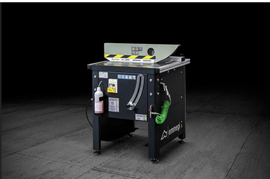
Одноголовочный обрезной станок с выходом подъемного режущего диска для резки экструдированных профилей и листового алюминия. Станок отличается особо прочной конструкцией, которая обеспечивает высокую точность резки, гарантирующей параллельность граней профиля. Кроме того, располагает оснащением для подключения опорных рольгангов для увеличения количества способов его применения. Защитный кожух режущего диска обеспечивает полную безопасность работы на станке.
