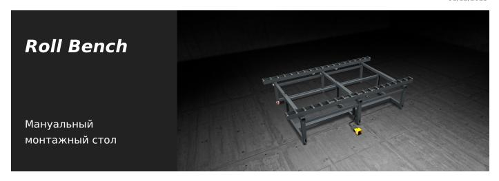
Модульный стол больших размеров предназначен для сборки и перемещения на линии секций фасада. Он оборудован двумя роликовыми конвейерами, покрытыми мягким ПВХ; расстояние между двумя роликовыми дорожками регулируется вручную в зависимости от ширины обрабатываемого переплета. Пневматическая система позволяет блокировать ролики при выполнении этапов технологического процесса.
