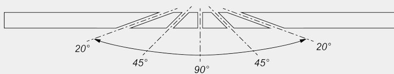
Механическая регулировка промежуточных углов наклона
