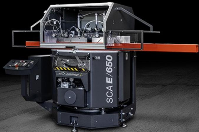
Подъемный одноголовочный пильный станок с автоматическим вращением вертикальной оси, управляемой ЧПУ, с помощью бесщеточного двигателя и одновременным гидравлически управляемым опрокидыванием горизонтальной оси. Резка с установкой углов от 90° до 22°30' (слева и справа) по вертикальной оси и от 90° до 35° (только справа) по горизонтальной оси.
