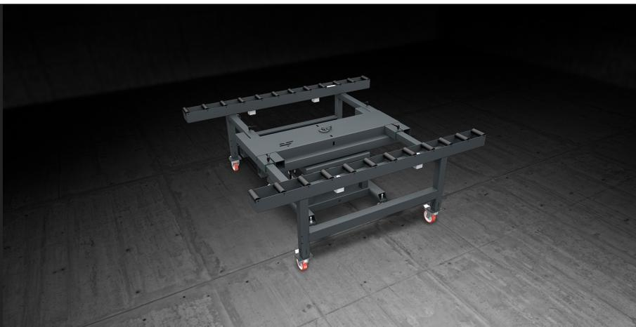
Модульный стол предназначен для сборки и перемещения на линии секций фасада. Он оборудован двумя роликовыми конвейерами, покрытыми мягким ПВХ; расстояние между двумя роликовыми дорожками регулируется в зависимости от ширины переплета. Пневматическая система позволяет блокировать ролики при выполнении этапов технологического процесса. Весь стол может поворачиваться на 360° с целью упрощения операций сборки и герметизации секции; наклонное положение удерживается пневматическим управлением.
