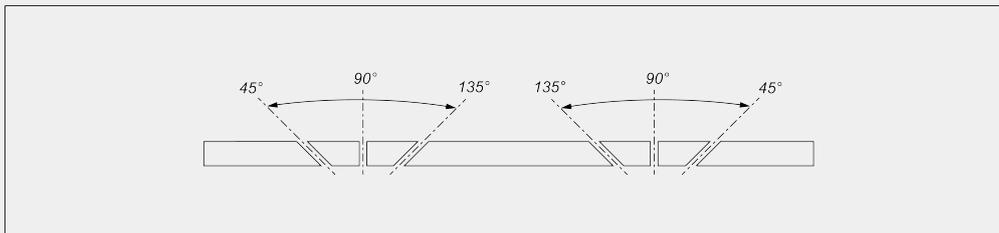
Электронная регулировка промежуточных углов наклона
