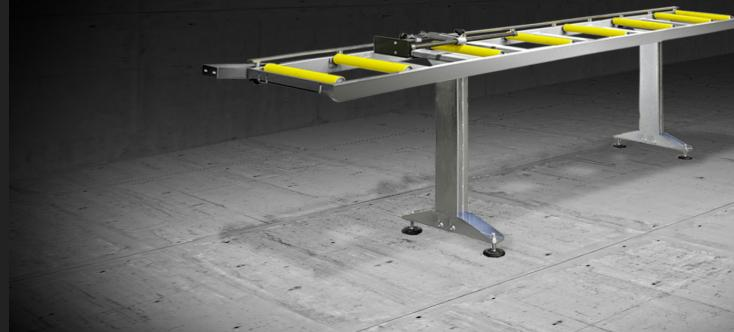
Стальная конструкция из трубчатых профилей с регулируемыми по высоте ножками и роликами, покрытыми ПВХ. С роликами шириной 240 мм длина рольганга составляет 3.500 мм; с роликами шириной 440 мм длина рольганга составляет 4.000 мм.
