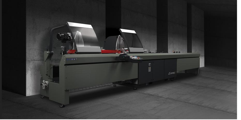
Sayısal kontrol tarafından idare edilen fırçasız motor aracılığı ile hareketli kafanın otomatik hareketine sahip elektronik çift kafalı kesici. Ara açılarının mekanik ayar sistemi ile kesim ünitelerinin 90° ile 22°30' (dış) arası pnömatik eğimi. Oleo-pnömatik bıçak ilerlemesi.
