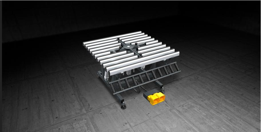
用于组装玻璃窗板的工作台，加工台面可从 0°（水平）到 85° 范围内倾斜。伸缩式辊筒输送机可以独立于加工台，高度可调（从 170 到 460 毫米）。工作台可在 895 至 965 毫米之间调整，支脚设有地面固定孔。工作台配备了一个中央十字杆，用于抬升并定位玻璃。
