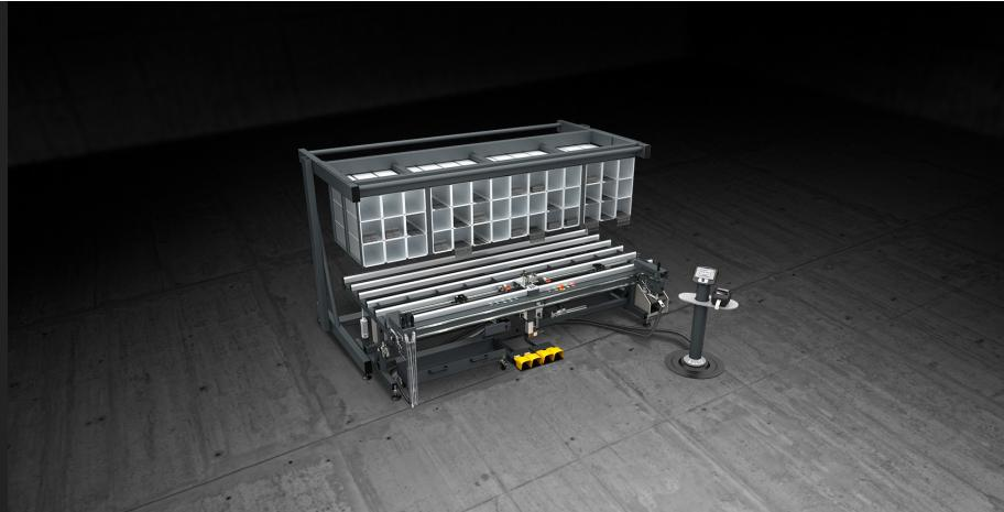
专用于五金件装配的工作台。具有宽大的工作台面、可以加工大尺寸窗框。工作台可包有 3 种不同材料（低摩擦 PVC 用于加工铝合金、刷子用于加工 PVC、毛毡用于加工木头） 、允许加工任何门窗。作为 BMF 3500 的标准配置、可以进行五金件的测量、通过液压气动剪床进行切割、并通过自动进给的拧紧装置拧紧。另外、还可以选择其它配件：长插销用的三轴钻孔机、长插销用的铣削套件、铰链孔用的钻孔机、切屑收纳抽屉、五金件仓和用磁性探头来测量玻璃固定槽的自动测量装置。
