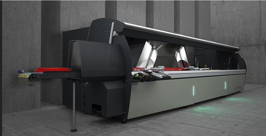
9 轴受控双头切割机、包括移动头的自动移动装置、切割单元两个旋转轴的电子管理装置、刀片的推进装置以及切割单元的垂直平移装置、能够以最大限度地扩大工作范围。这款切割机可以在水平轴上达到 45° (内部) 到 22°30' (外部) 、垂直轴上从 0 到 45° 的角度、并具有小数位的切割精度。机器有两个版本：Compound Cut L 用于切割截面较大、正常厚度的轻质型材；Compound Cut H 用于切割抗切割性能较高、厚度较大、或其几何形状需要刀片接触弧长较大的重型型材。600 毫米的 Widia 刀片可在两个轴上推进、从而优化垂直方向的切割形状、能够切割高度超过 500 毫米的型材、并能确保以最佳方式调整刀片速度和输出行程。HS (高速) 版配有高速 X 轴和自动加工所需的所有护板。
