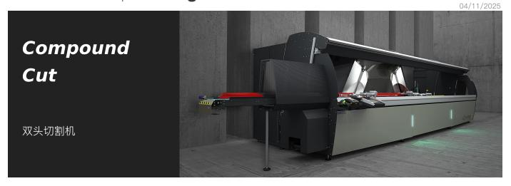
9 轴受控双头切割机、包括移动头的自动移动装置、切割单元两个旋转轴的电子管理装置、刀片的推进装置以及切割单元的垂直平移装置、能够 以最大限度地扩大工作范围。这款切割机可以在水平轴上达到 45°(内部) 到 22°30′(外部)、垂直轴上从 0 到 45°的角度、并具有小数位的 切割精度。机器有两个版本: Compound Cut L 用于切割截面较大、正常厚度的轻质型材; Compound Cut H 用于切割抗切割性能较高、厚度 较大、或其几何形状需要刀片接触弧长较大的重型型材。 600 毫米的 Widia 刀片可在两个轴上推进、从而优化垂直方向的切割形状、能够切割 高度超过 500 毫米的型材、并能确保以最佳方式调整刀片速度和输出行程。HS(高速)版配有高速 X 轴和自动加工所需的所有护板。
