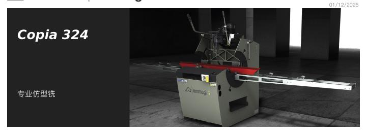
手动控制的单头受电弓,可以进行气动夹持并通过间接杠杆平移切割头。可以在不转动工件的情况下对铝质型材进行通体式加工。防刮加工台面。手动控制探头。
