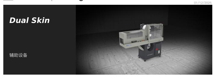
在铝型材上粘贴保护膜的机床。型材由电动辊筒自动送入,并通过压力辊筒确保薄膜与型材完美粘合。额外的选配套件还允许同时将薄膜粘贴 于第三个面。
