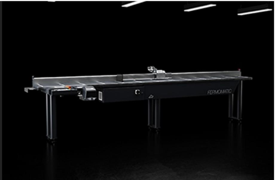
测量反馈和型材支撑系统配有使用无刷电机的止动件移动装置、以及通过编码器进行读数的电子读数装置。提供三种长度、定位精度高且可重复定位。
