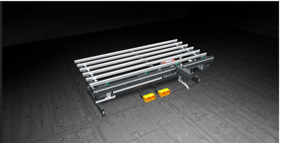
专门用于在铝、木和 PVC 窗板上组装周边条形五金件的工作台。一个可伸缩的虎钳系统可以固定窗板。该工作台配备了一个自带动力的螺丝拧入系统、以及测量并使用液压气动剪切机切割五金件的选配系统。
