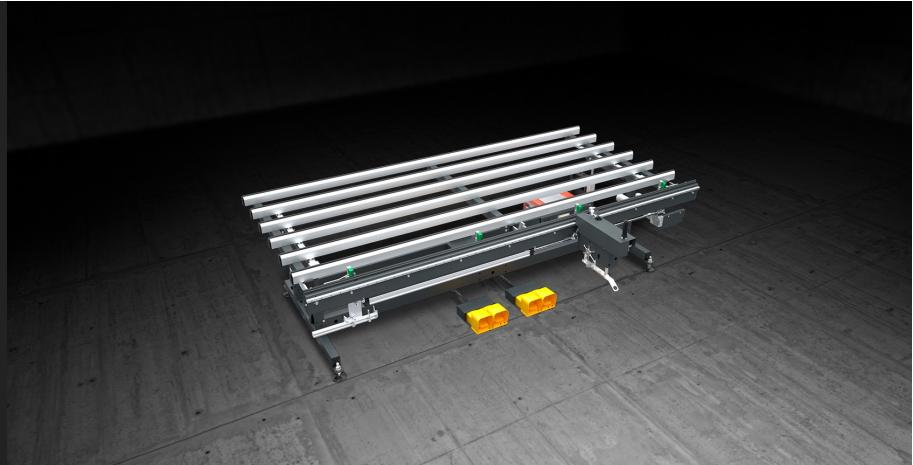
专门用于在铝、木和 PVC 窗板上组装周边条形五金件的工作台。一个可伸缩的虎钳系统可以固定窗板。该工作台配备了一个自带动力的螺丝拧入系统、以及测量并使用液压气动剪切机切割五金件的选配系统。
