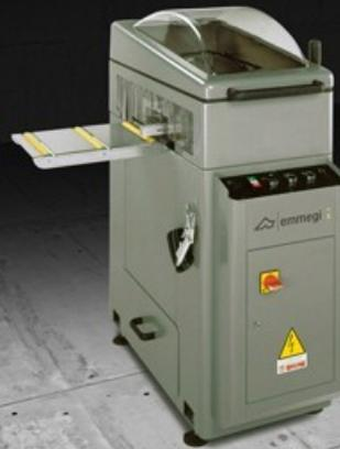
水平端面铣削机，带电动气动进给装置。方框外铣削角度  $+45^{\circ}/90^{\circ}/-$
