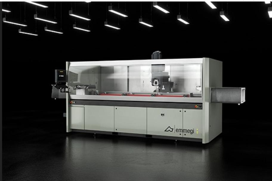
带有 4 个控制轴的数控加工中心，刀具可以自动旋转，从而对工件的 3 个面进行加工。加工中心专门用于加工最大厚度 2 毫米的铝、PVC、一般轻合金的棒材或工件。配有一个 9 刀位的手动刀具库，保护舱左侧有一个 4 刀位的自动刀具库。另外还可以在保护舱右侧选配一个 4 刀位的自动刀具库。型材通过一个位于左侧的气动挡块进行定位，通过 4 个 X 轴自动定位的坚固虎钳进行夹持。可选择在右侧安装第二个气动挡块，以允许对两倍于加工长度范围的棒材进行超大尺寸加工。所有数控轴都是绝对轴、在机床重新启动时不需要重新设置。加工中心还配有一个活动工作台，方便工件装卸，大大增加了可加工截面。
