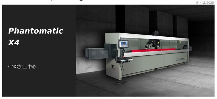
带有 4 个控制轴的数控加工中心、专门用于加工铝、PVC、一般轻合金和 2 毫米及以下钢材质的棒材或工件。配有一个 8 刀位的刀具库、可以容纳一个转角单元和一个圆盘铣刀、用于加工工件的 5 个面、可以加工最长为 4 米的棒材。第 4 数控轴允许电动主轴在 0°到 180°
