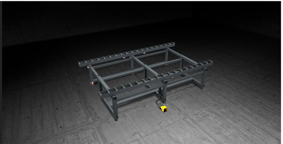
专门用于外墙单元在生产线上装配和移动的大尺寸模块化工作台，配备两条辊筒轨道，上面覆盖着软质的 PVC 护套；两条轨道之间的距离可根据待加工窗框的宽度手动调节。一个可气动操纵的系统能够在加工阶段锁定辊筒。
