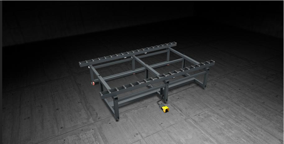
专门用于外墙单元在生产线中装配和移动的大尺寸模块化工作台，配备两条辊筒轨道，上面覆盖着软质的 PVC 护套；两条轨道之间的距离可根据待加工窗框的宽度手动调节。一个可气动操纵的系统能够在加工阶段锁定辊筒。
