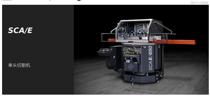
上升式单头切割机、带有无刷电机驱动的垂直轴数控自动旋转装置、水平轴还可以通过液压控制同时实现翻转。垂直轴上的切割角度为 90° 至 22°30'(左右两侧)、水平轴上为 90°至 35°(仅右侧)。
