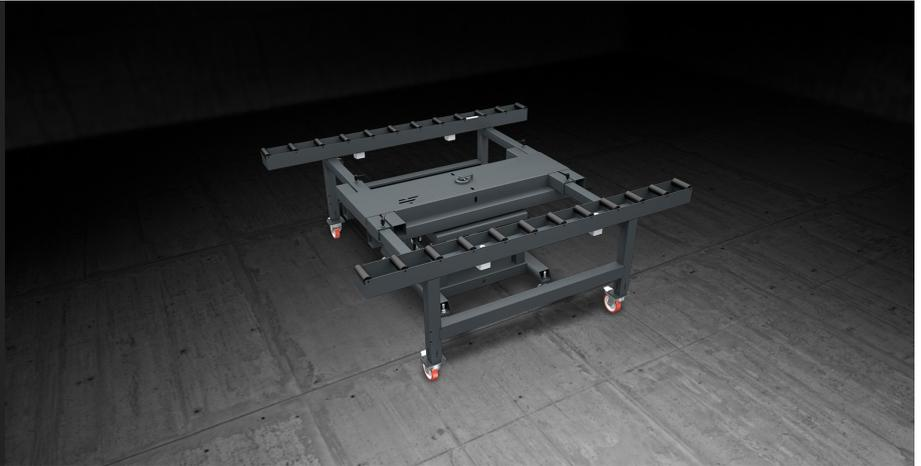
专门用于外墙单元在生产线上装配和移动的模块化工作台，配备两条辊筒轨道，上面覆盖着软质的 PVC 护套；两条轨道之间的距离可根据窗框的宽度进行调整。一个可气动操纵的系统能够在加工阶段锁定辊筒。整个工作台可以 360° 旋转，以方便外墙单元内的组装和密封操作；气动控制器负责锁定角度位置。
