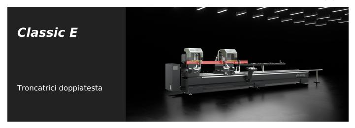
Troncatrice doppiatesta elettronica con movimento automatico della testa mobile tramite motore brushless comandato da un controllo numerico. Inclinazione pneumatica delle unità di taglio in 3 posizioni fisse 90°, 45° e 22°30′ (esterna) oppure con sistema meccanico di regolazione manuale delle angolazioni intermedie. Avanzamento lama oleo-pneumatico.
