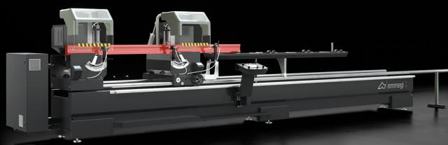
Troncatrice doppiatesta elettronica con movimento automatico della testa mobile tramite motore brushless comandato da un controllo numerico. Inclinazione pneumatica delle unità di taglio in 3 posizioni fisse 90°, 45° e 22°30' (esterna) oppure con sistema meccanico di regolazione manuale delle angolazioni intermedie. Avanzamento lama oleo-pneumatico.
