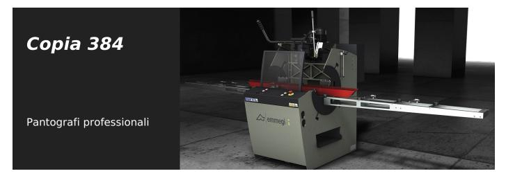
Pantografo monotesta a comando manuale con bloccaggio pneumatico e movimento di traslazione testa attraverso leva indiretta. Velocità di rotazione utensile modificabile con variatore elettronico per permettere le lavorazioni su acciaio fino a 2 mm, e per migliorare la qualità delle fresature e la durata dell'utensile. Possibilità di eseguire lavorazioni passanti su alluminio senza girare il pezzo. Piano di lavoro antigraffio. Tastatore a comando manuale.
