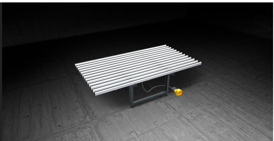
Banco per l'assemblaggio di ante e telai. Banco orizzontale con scambio pneumatico fra il piano di appoggio in PVC morbido (per la fase di assemblaggio) e il piano di appoggio in PVC duro antirifrazione (per la fase di movimentazione). Il piano di lavoro è regolabile in altezza da 895 a 965 mm e i piedini sono provvisti di fori per il fissaggio in terra.
