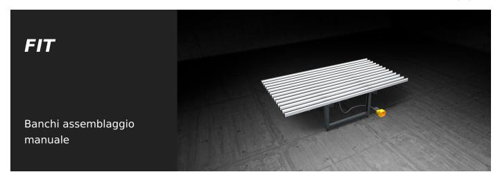
Banco per l'assemblaggio di ante e telai. Banco orizzontale con scambio pneumatico fra il piano di appoggio in PVC morbido (per la fase di assemblaggio) e il piano di appoggio in PVC duro antifrizione (per la fase di movimentazione). Il piano di lavoro è regolabile in altezza da 895 a 965 mm e i piedini sono provvisti di fori per il fissaggio in terra.
