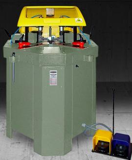
Cianfrinatrice per chiudere angoli di profilati in alluminio di tutte le tipologie. Facile da regolare grazie alla traslazione delle unità di punzonatura. I blocchi coltelli sono dotati di sgancio rapido e calamite per evitare la caduta degli stessi. Facile da utilizzare e versatile.
