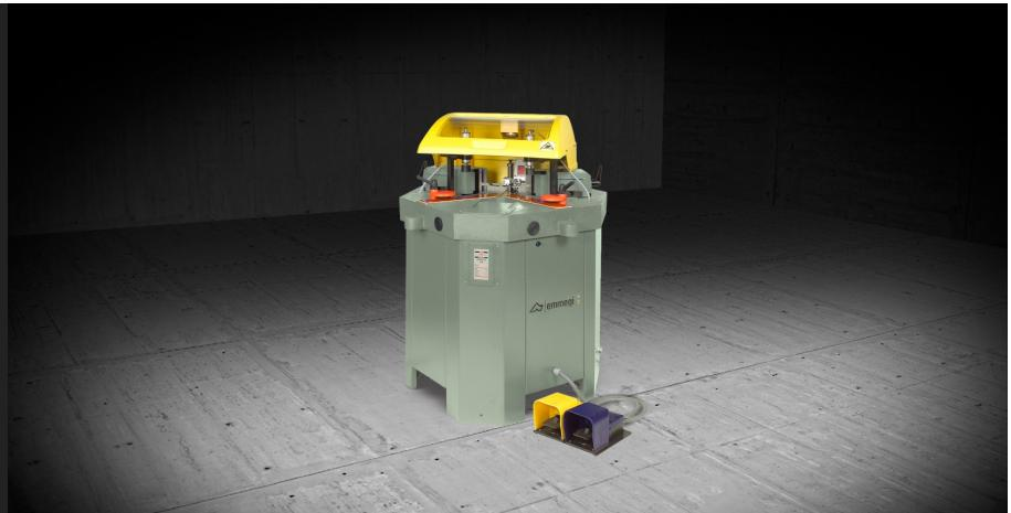
Cianfrinatrice per chiudere angoli di profilati in alluminio per porte, finestre, e facciate. Facile da regolare grazie alla traslazione delle unità di punzonatura. I blocchi coltelli sono dotati di sgancio rapido e calamite per evitare la caduta degli stessi. Dotata di lettura digitale dello spostamento delle teste di cianfrinatura e della forcella di riferimento dei profilati. Le regolazioni sono semplificate dalla facilità di lettura del display.
