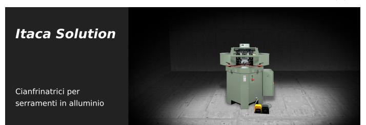
La macchina ha due teste operatrici particolari equipaggiate con masse in cui i 2 coltelli sono regolabili su tutte le posizioni di cianfrinatura. I coltelli si spostano e sono regolabili sull'asse Y (lungo il profilato), sull'asse Z (alto-basso) e sull'asse X (lungo la direzione di cianfrinatura). Queste condizioni evitano la sostituzione sulla macchina degli utensili indipendentemente dai diversi tipi di profilato. Si riducono, così, i tempi ed i costi di piazzamento.
