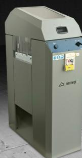
Intestatrice orizzontale ad avanzamento manuale. Fresatura in quadro a 90°. Cambio rapido del gruppo frese con comando a leva. Piano di lavoro antigraffio. Protezione integrale zona lavoro.
