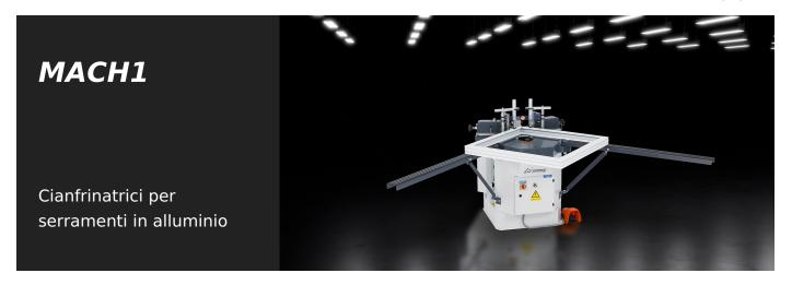
Cianfrinatrice pneumatica per la pressatura di profili di grandi dimensioni e facciate strutturate, con elevati requisiti di qualità. I suoi maggiori punti di forza sono: la facilità di configurazione e uso, con tempi di attrezzaggio e regolazione ridotti al minimo; l'estrema robustezza della struttura che conferisce alta precisione alla lavorazione; la grande forza di pressatura è fornita da un cilindro a soffietto di grande volume che non richiede manutenzione.
