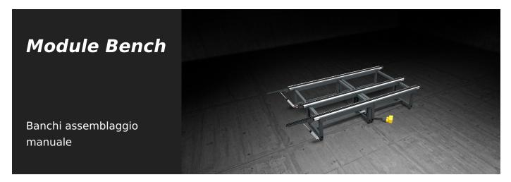
Banco modulare di grandi dimensioni, estensibile, dedicato all'assemblaggio di serramenti e celle di facciata. È corredato di 3 piani di lavoro distinti: uno con PVC morbido per le operazioni di assemblaggio, uno con PVC duro antifrizione per la rotazione ed una rulliera per lo spostamento in linea.
