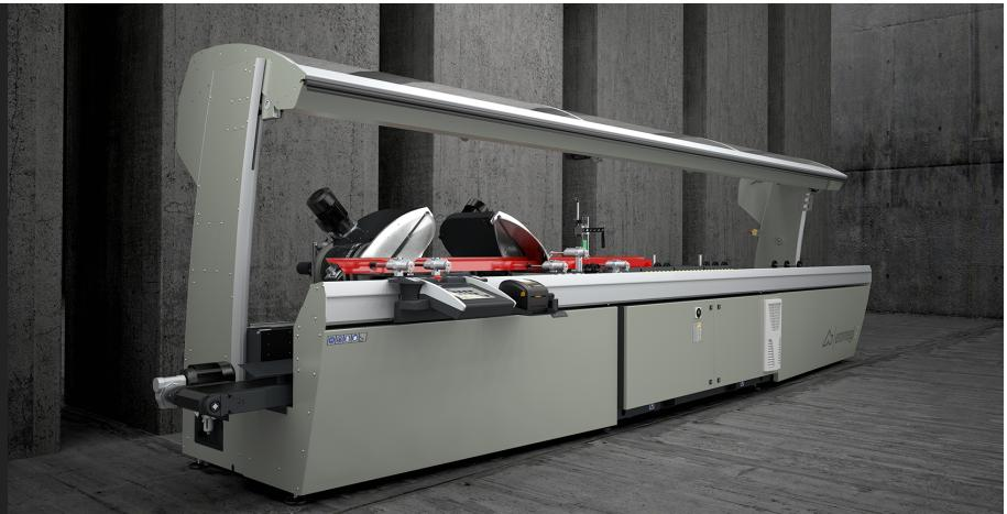
Troncatrice doppiatesta a 3 assi controllati per alluminio, PVC e leghe leggere, con movimento automatico della testa mobile e gestione elettronica di tutte le angolazioni da 45° (interni) a 15° (esterni) con una precisione, all'interno di ogni grado, di 280 posizioni. Nella versione base, l'avanzamento lama è azionato da una coppia di cilindri oleo-pneumatici. Lama da 550 mm. Disponibile con taglio utile di 5 m o 6 m di lunghezza.
