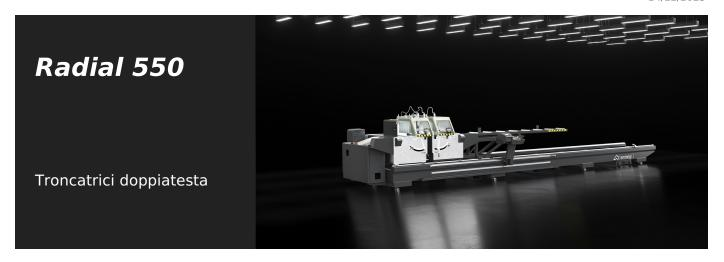
Troncatrice doppiatesta elettronica con movimento radiale delle lame, spostamento automatico della testa mobile su pattini a ricircolo di sfere tramite sistema a pignone e cremagliera; ribaltamento interno fino a 30°, studiata per il taglio di profili di grandi dimensioni. L'avanzamento lama è azionato da una coppia di cilindri oleo-pneumatici.
