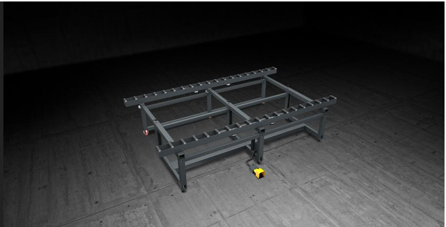
Banco modulare di grandi dimensioni dedicato all'assemblaggio ed alla movimentazione in linea di celle di facciata. È correddato di due piste di rulli ricoperti con guaina di PVC morbido; la distanza tra le due piste è regolabile manualmente in base all'ampiezza del serramento che si deve lavorare. Un sistema azionabile pneumaticamente consente di bloccare i rulli durante le fasi di lavoro.
