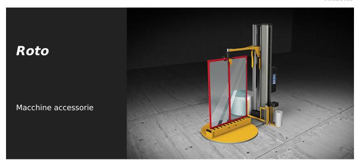
Imballatrice verticale per infissi. Il piano di appoggio è rotante ed è dotato di rulliera per facilitare la movimentazione di pezzi pesanti o di grandi dimensioni. La macchina è concepita per essere utilizzata da un solo operatore.
