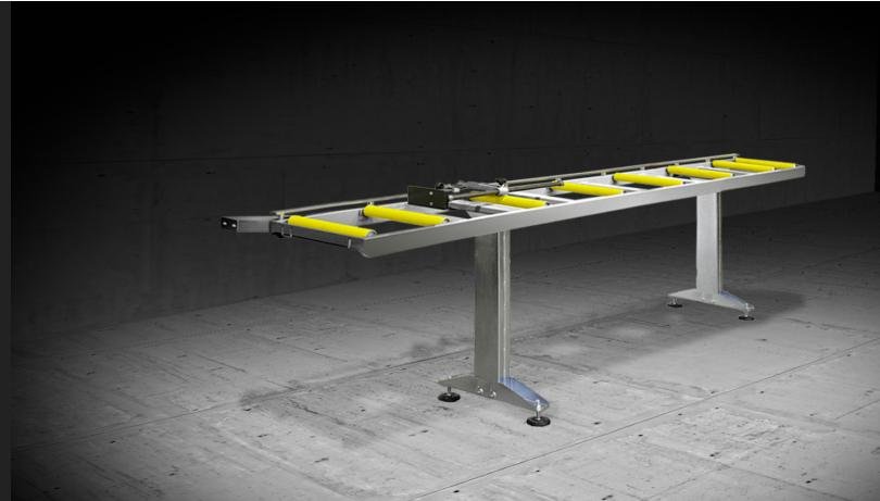
Struttura in tubolare d'acciaio con piedi registrabili e rulli in acciaio rivestiti in PVC. Rulli da 240 mm con lunghezza rulliera di 3.500 mm, o rulli da 440 mm con lunghezza rulliera di 4.000 mm.
